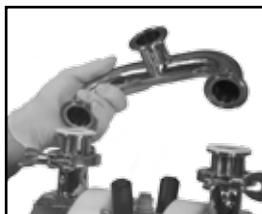
6.2.8 Rimuovere il collettore di aspirazione
