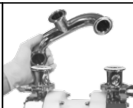
6.3.19 Posizionare le guarnizioni e il collettore di aspirazione
